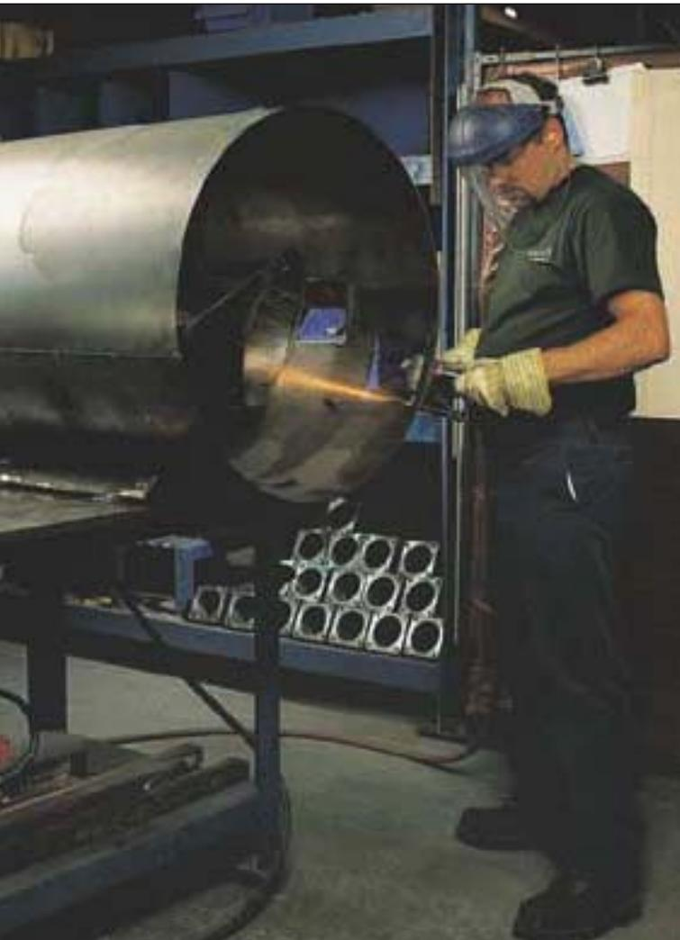
une main, ou un pied, n'offre pas une stabilité suffisante : la meuleuse pourrait déraiper. Le cylindre est donc déposé sur un support formé de deux cornières (fers angles) soudées sur deux bandes transversales. Pour changer l'orientation du cylindre, il suffit de le faire pivoter sur les cornières, qui font office de cales. Ingénieux !
